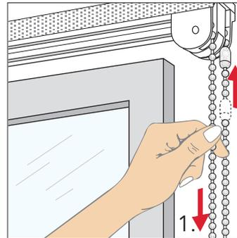
**1.** Perlkette bis zum Anschlag des Kettenschlosses hochziehen
